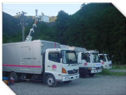
▲高圧発電機車
