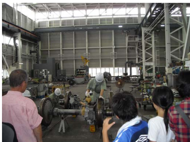
▲ 取り外して整備される車輪
